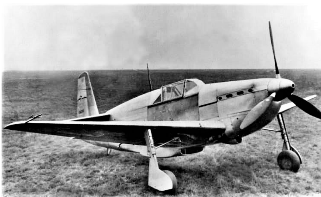
Le CAO 200, ici avant montage des dérives supplémentaires, source 1000aircraftphotos
